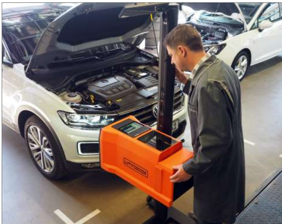
Digitales Scheinwerfer-Einstell-Prüfgerät (SEP) mit automatischem Nivellierausgleich
